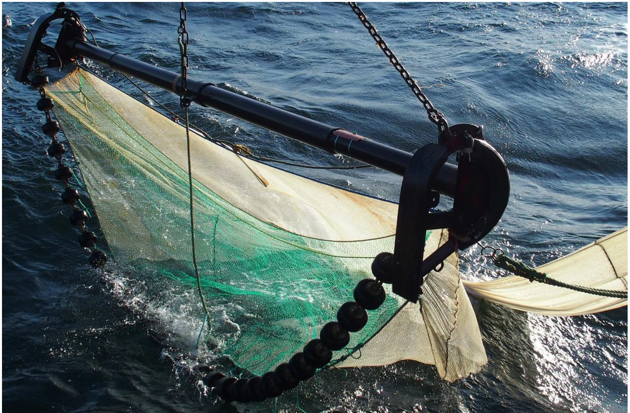
Abbildung 7: Die obere Spannleine ist nur an den Kurrschuhen befestigt, die untere hier überflüssige Spannleine ist lose und zieht die Siebmatte horizontal zusammen.
