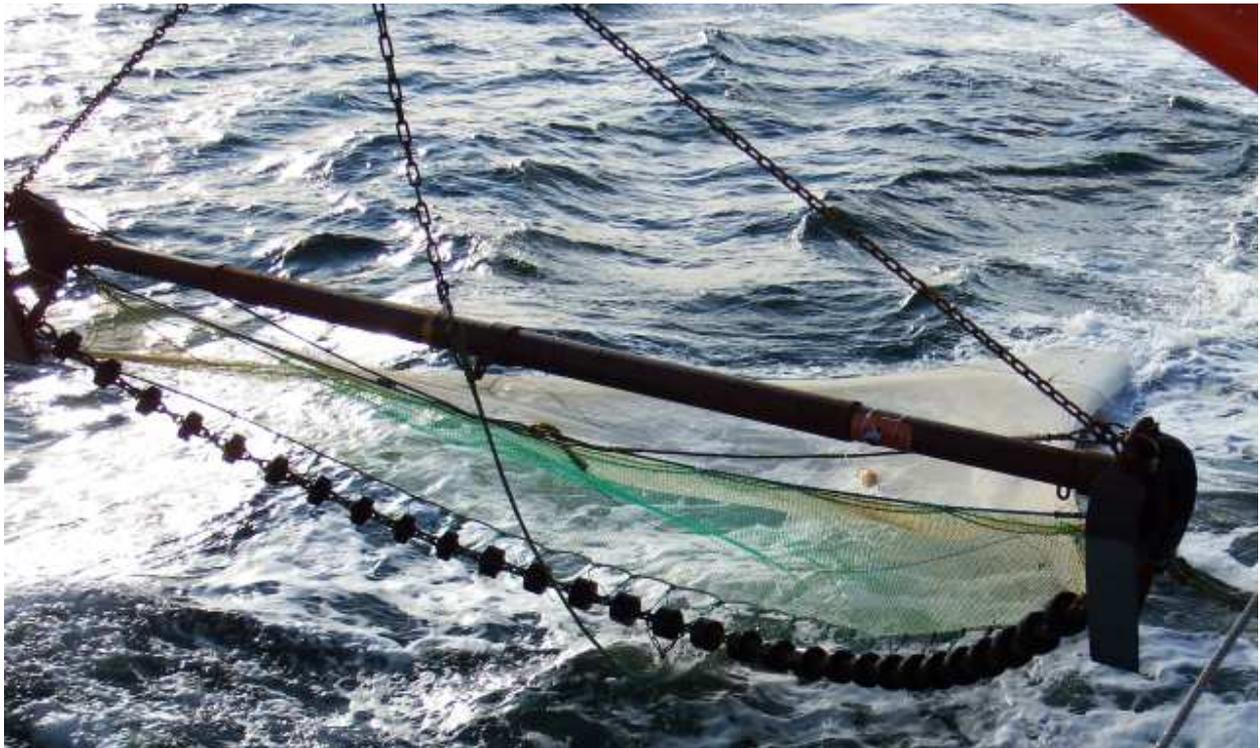
Abbildung 11: Die Siebmatte wurde mit beiden zusammengefassten Spannleinen am Kopftau befestigt, die Siebmatten-Seiten sind noch lose.
