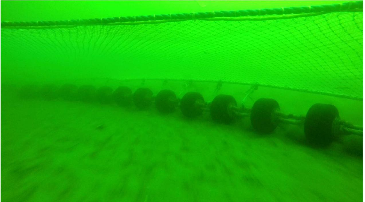
Abbildung 13: Die obere Siebmatten-Spannleine wurde am Kopftau durchgehend befestigt, die Siebnetzseiten wurden an einer Fischleine aufgefädelt, die untere Spannleine ist entnommen. Das Grundtau befindet sich zu weit über dem Rollentau.
