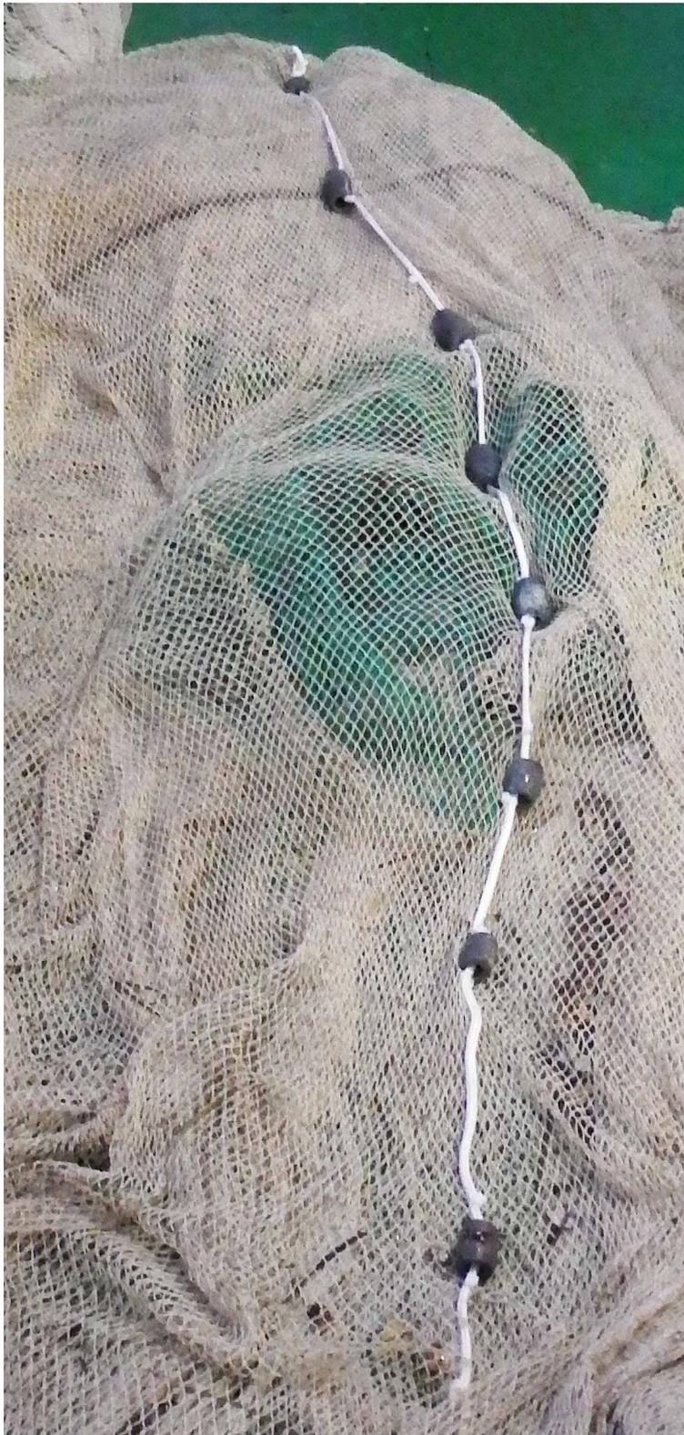
Abbildung 24: Bleistücke, die nachträglich auf der mittleren Maschenreihe des Auffangsteertes angebracht wurden
