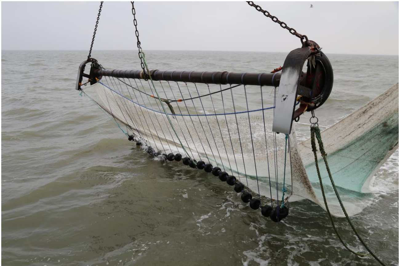
Abbildung 8: 7 m- Baumkurre mit geradem Grundtau Figure 8: 7 m beam trawl with straight ground rope
