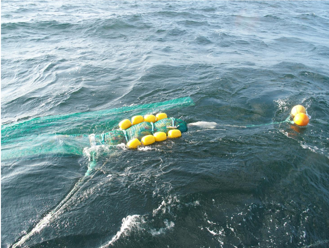
Abbildung 17: mit 0,5 m 3 Fangimitat gefüllter Steert mit 4 Ringverstärkungen um den Hievsteert, hinter dem Hievstropp EVA-Floats mit 40 kgf Gesamt-Auftrieb an den Laschen, sowie einer Steertboje aus 2 m Leine und 2 Stck. 28 mm Kugeln mit jeweils 8,2 kgf Auftrieb Figure 17: codend filled with 0.5 m 3 catch imitation with 4 ring reinforcements around the codend, EVA floats with 40 kgf total buoyancy at the selvages behind the lifting strap, as well as a codend buoy consisting of 2 m rope and 2 pcs. 28 mm spheric floats each with 8.2 kgf buoyancy
