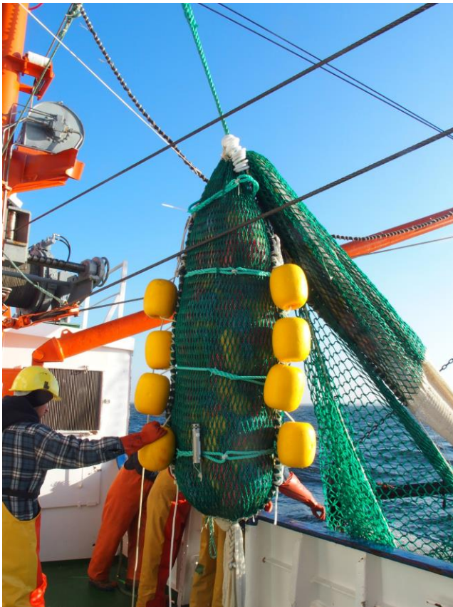
Abbildung 13: Baumkurrensteert mit 4 Ringverstärkungen und Plastik-Fangimitat
