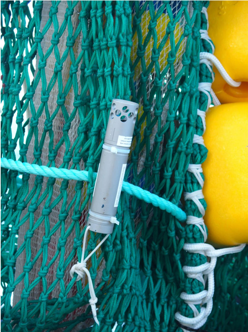
Abbildung 7: STARMON- Neigungswinkel-Tiefen- Logger Figure 7: STARMON Tilt- Depth- Logger
