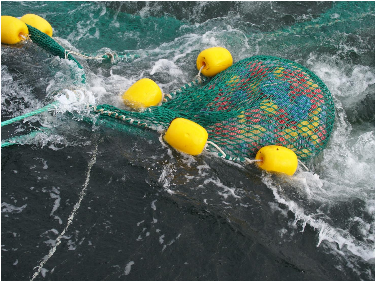
Abbildung 11: Plastik-Topfkratzer (Scheuerpads) als Simulation für den Fang Figure 11 : Plastic scouring pads as simulation for the trawl catch
