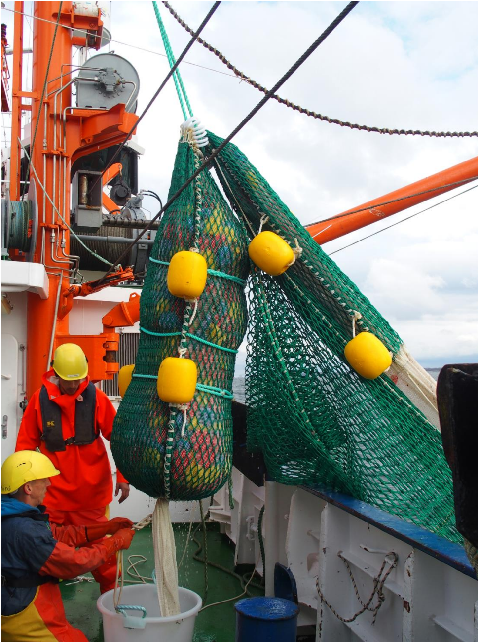
Abbildung 16: Baumkurrensteert mit 3 Ringverstärkungen und Plastik-Fangimitat Figure 16: Beam trawl cod end with 3 ring reinforcements and plastic catch imitation
