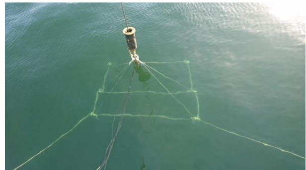
Abbildung 4: A, B) Positionierungssystem BlueROV. Die Hydrophone sind an den Ecken des Gestells angebracht.
