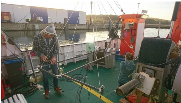
Abbildung 4: A, B) Positionierungssystem BlueROV. Die Hydrophone sind an den Ecken des Gestells angebracht.
