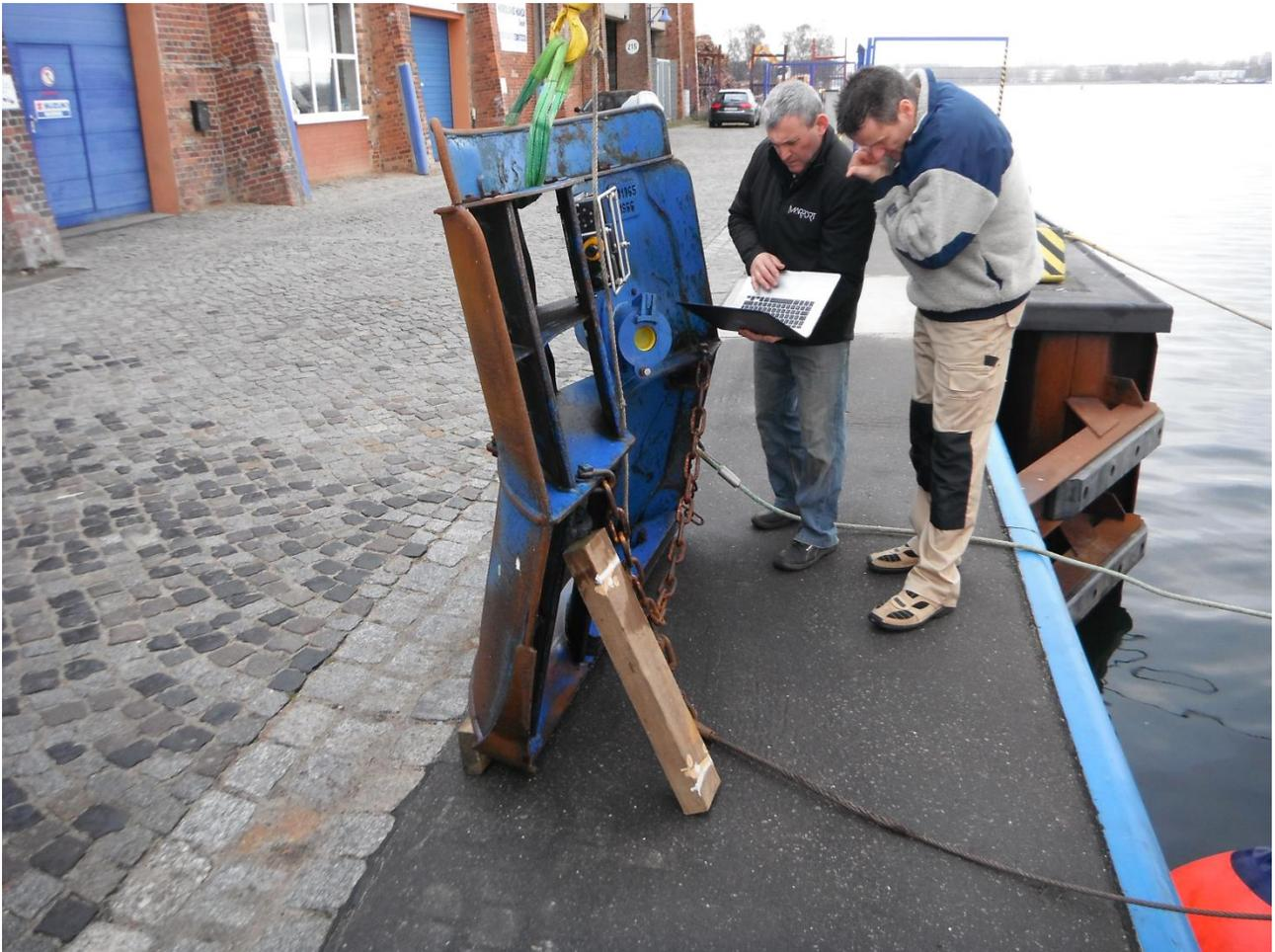
Abbildung 19: Eichung des Marport-Scherbrettsensors am ausgerichteten Scherbrett
