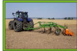
Bodenbearbeitung mit dem Grubber Amazone Cenius 3002-T, oben: angebaut, unten: angehängt.
