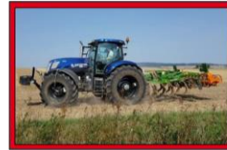
Bodenbearbeitung mit dem Grubber Amazone Cenius 3002-T, oben: angebaut, unten: angehängt.
