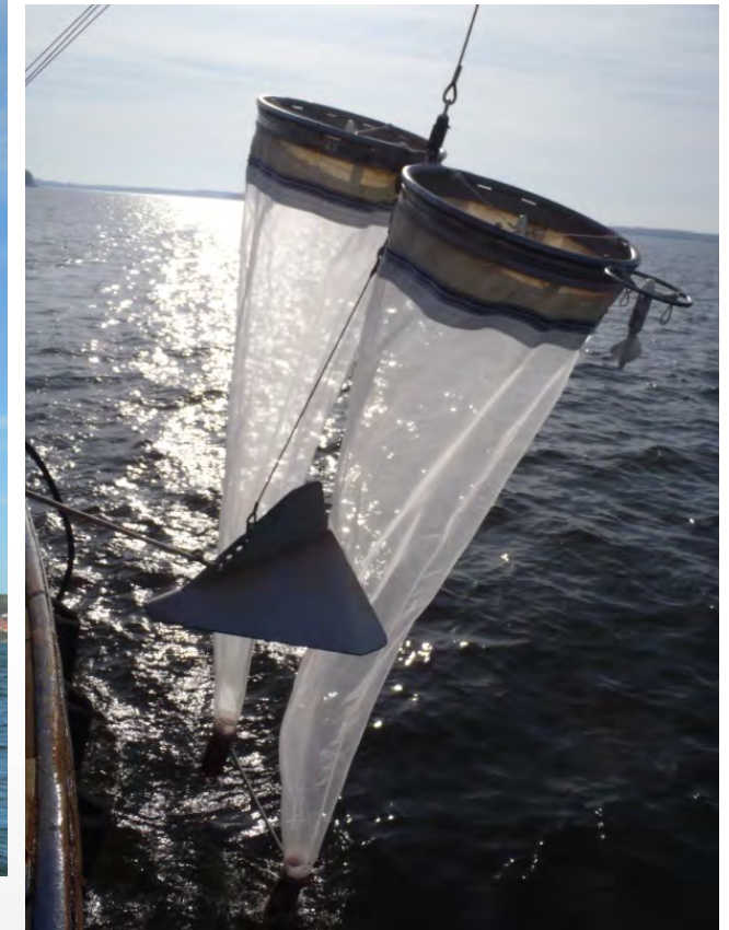
Plankton-Netz (Bongo-Netz) (Maschenweiten: 335/780 \mu\text{m} )
