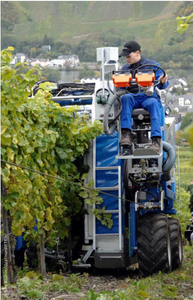
Die Mechanisierung hat auch im Weinbau die Arbeit vereinfacht. In den Steillagen bei Bernkastel-Kues an der Mosel wird im September 2007 erstmals die Weinlese mit einem Steillagen-Vollernter durchgeführt.
