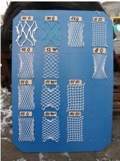
Netzproben mit verschiedenen Maschenweiten und -typen (Raute, 90°, 45°) (Foto: Thünen-Institut)
