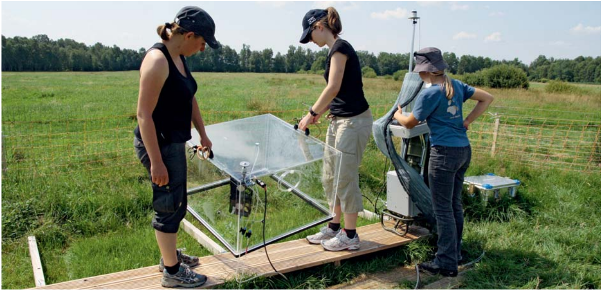
Abb. 3: Umsetzen der Messhaube für die nächste CO 2 -Flussmessung, v.l.n.r. Bärbel Tiemeyer, Linn Schröder und Katharina Leiber-Sauheitl.
