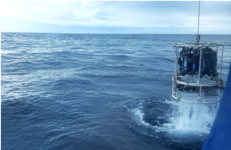
Eine hydrografische Sonde mit Kranzwasserschöpfer zur Bestimmung von Salzgehalt und Temperatur mit der Wassertiefe. (© Thünen-Institut/Sakis Kroupis)
