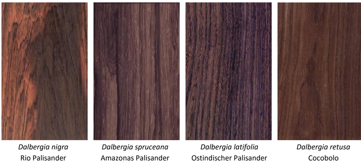
Abb. 2: Holzoberflächen unterschiedlicher Palisander-Arten, die sich makroskopisch nur schwierig unterscheiden lassen.
