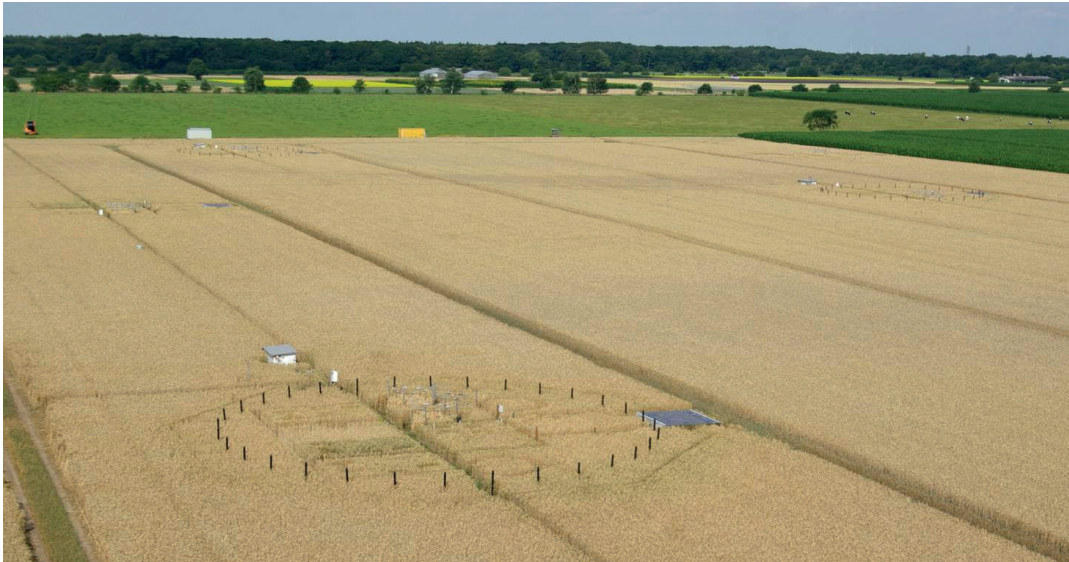
FACE-Versuchsfeld mit CO 2 -Begasungsringen (Ø 20 m). Durch Düsen an den senkrechten Stangen wird während der Vegetationsperiode computergesteuert CO 2 ins Ringinnere geblasen, sodass dort die mittlere CO 2 -Konzentration etwa 550 ppm beträgt (normale Umgebungsluft zzt. 390 ppm).
