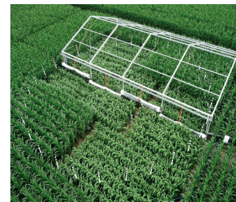
Mit »Rain sheltern« lassen sich zusätzlich Trockenheitseffekte untersuchen: Bei Regen spannt sich ein Dach über die Hälfte der Ringfläche (hier: Hirse).
