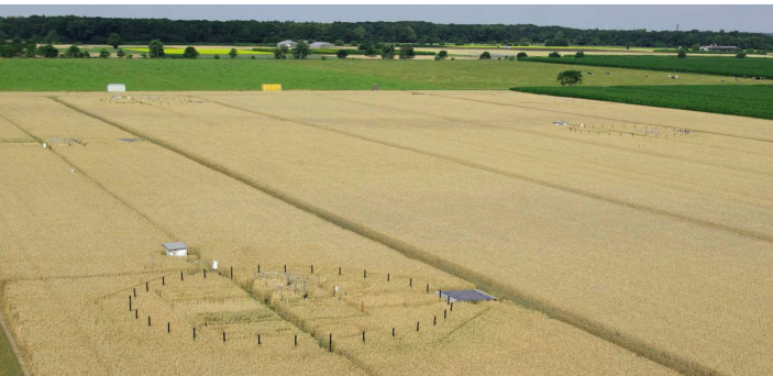
FACE-Ringe auf dem Versuchsfeld (Winterweizen) in Braunschweig
