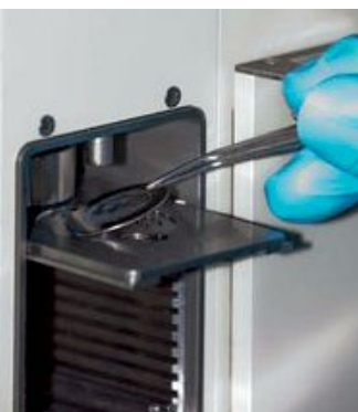
Edelstahlplättchen mit Alphastrahlern aus einer Fischprobe wird in den Detektor gelegt.
