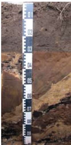
Im November wurde im Rahmen der BZE LW der 1.000ste Standort kartiert. Es handelte sich um einen Treposol aus abgetorfem Hochmoor im Emsland.
