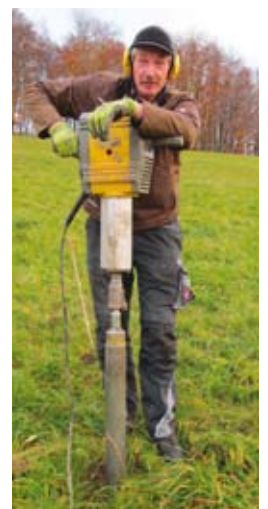
Rammkernsondierung mit dem Abbruchhammer
