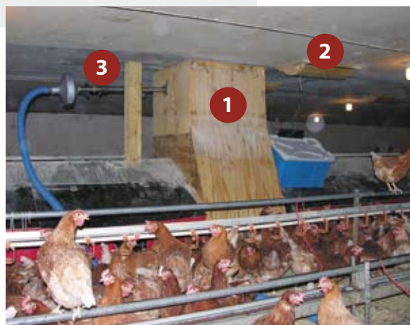
Emissionsmessung im Hühnerstall: (1) Abluftkanal, (2) Sensoren für Temperatur, Luftfeuchte und Ammoniak, (3) Gesamt- und Feinstaubmessung
