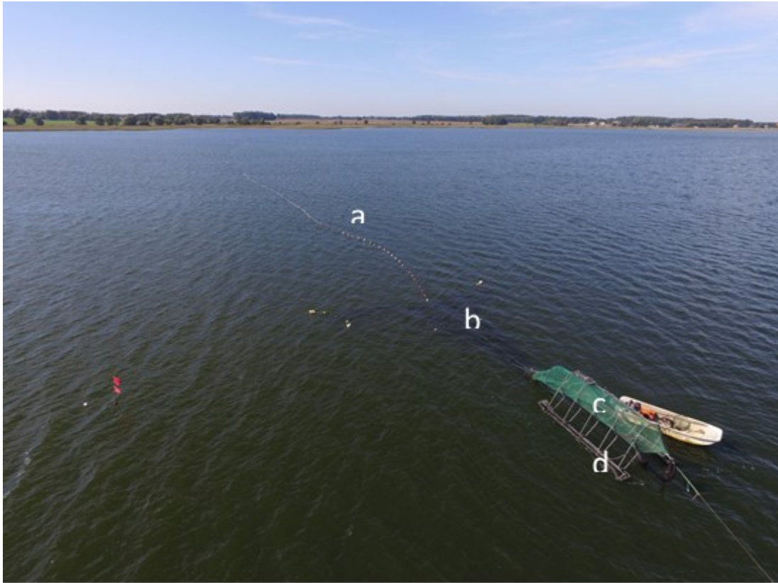
Abbildung 21: STELLA-Untersuchungen zur Ponton-Hebereuse in deutschen Gewässern: Luftaufnahme der Schwimmreuse mit Ponton-Hebereuse-Fangkammer (Standort: Prohner Wiek). Zu sehen ist: a) Leitwehr der Schwimmreuse; b) Rückfang der Schwimmreuse (Netz als dunkler Schatten unter Wasser zu erkennen); c) Fangkammer der Ponton-Hebereuse (altes Design), d) eine Kufe mit Auftriebskörper/Luftkammer
