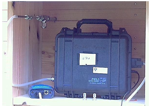
Abbildung 13: Luftprobenahme am Beispiel mit Tenax TA Sorptionsröhrchen
