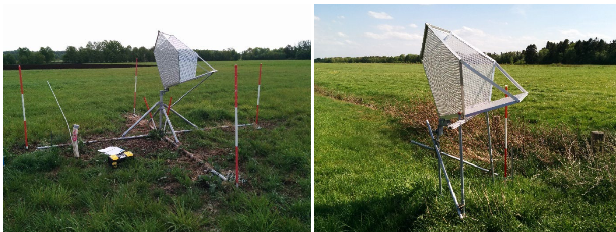
Abbildung 47: Radarreflektoren auf einer Grünlandfläche nach der Installation. Links: der Reflektor liegt mit seinem Unterbau auf der Torfoberfläche und bewegt sich mit der Geländeoberfläche auf und ab (links). Rechts: der Reflektor ist über ein Gestänge, welches durch eine Verrohrung von den Bewegungen des Torfkörpers isoliert ist, im mineralischen Untergrund verankert (rechts).
