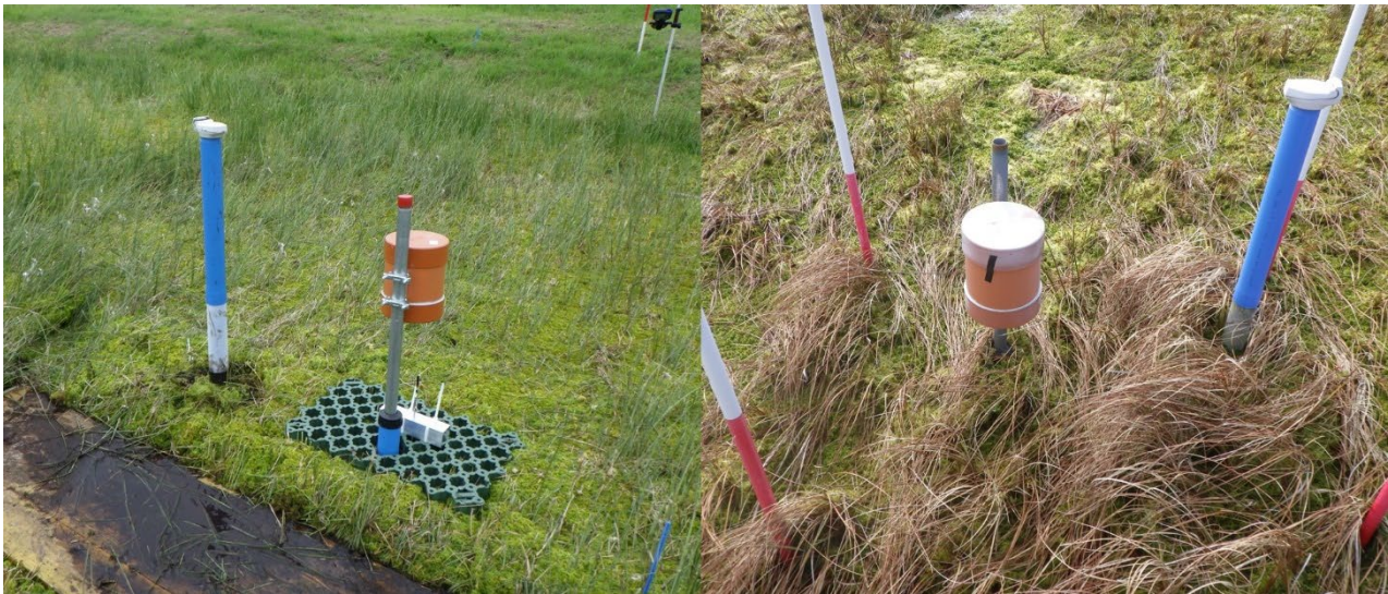
Abbildung 35: Seilzugsensor auf der Monitoringfläche bei der Einrichtung im Juni 2022 (links) und bei einer Wiedervermessung im März 2025 (rechts).
