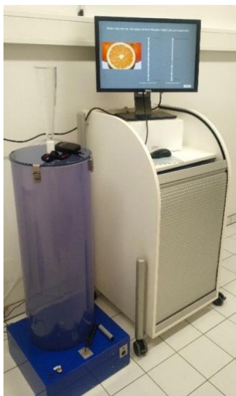
Anhang Abbildung 1: Geruchspräsentation mittels PureSniff XL, einem Gerät, das es den Versuchspersonen ermöglicht, die Freisetzung des Geruchs selbstständig auszulösen.
