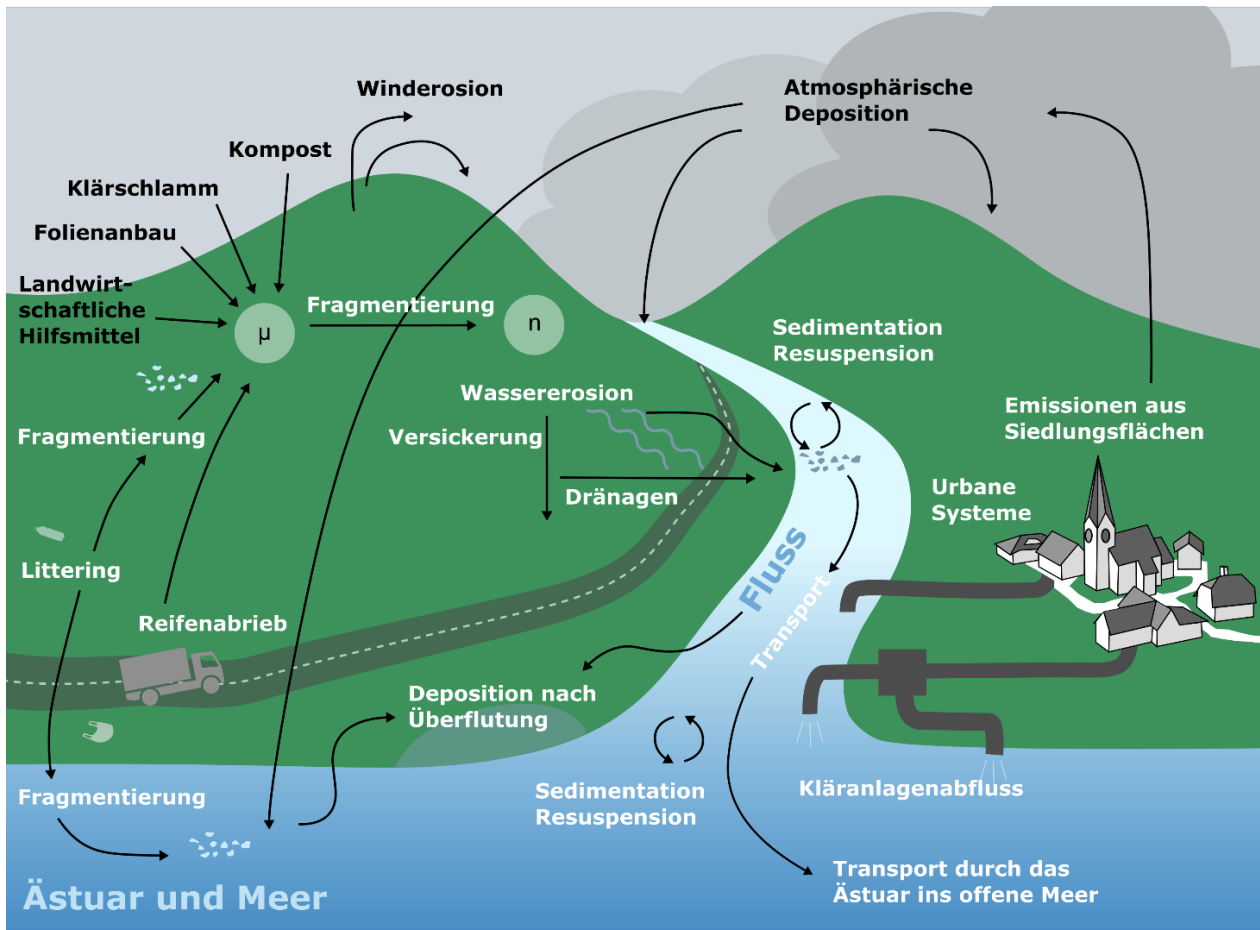
Abbildung 1: Quellen, Einträge und Transportpfade von Mikroplastik in einem Flusssystem und dem angrenzenden Küstenbereich
