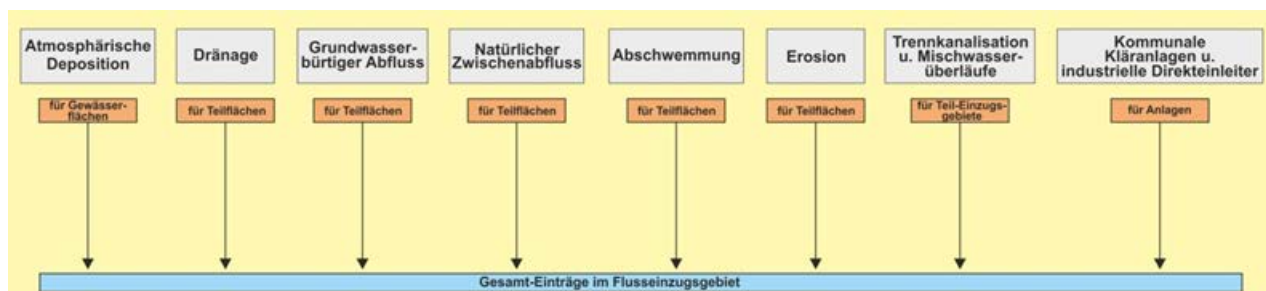
Abbildung 32: Schematische Darstellung der Modellierung des mehrjährigen mittleren Phosphoreintrags mit MEPhos
