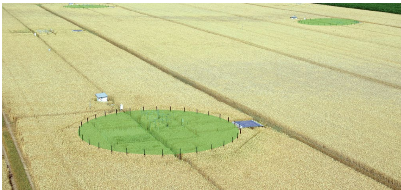
Foto 1: Freiland- \text{CO}_2 -Anreicherungsringe (FACE-System) in einem Winterweizenbestand im Juli in Braunschweig. Innerhalb der von vertikalen Ausströmröhrn begrenzten Ringfläche (hellgrün) kann die \text{CO}_2 -Konzentration dauerhaft erhöht werden.
