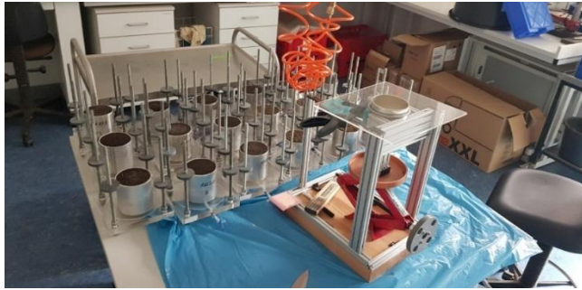
Abbildung 1: Vorbereitung von Bodenproben für ^{15}\text{N} -Gasfluss-Experimente. Die Gülleausbringung durch definierte ober- oder unterirdische Ausbringung erfolgt mit Hilfe der Spezialvorrichtung im Vordergrund (Quelle: Balázs Grosz).
