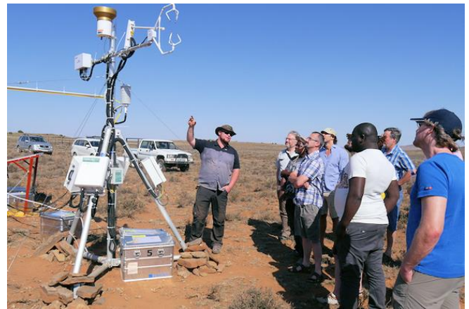
Abbildung 2: Messturm zur Bestimmung des CO 2 -Austausches zwischen Ökosystem und Atmosphäre in Eastern Karoo, Südafrika
