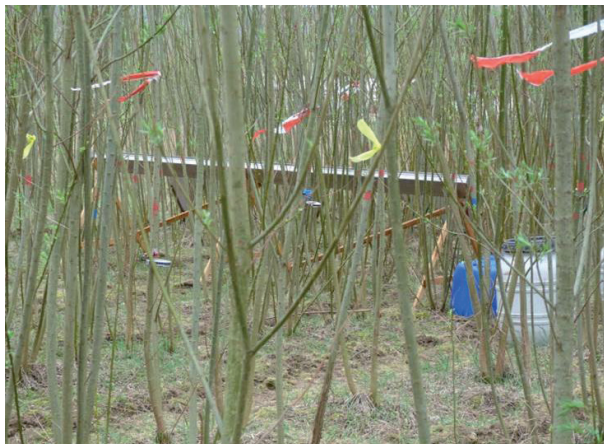
Abbildung 5 Messung des Bestandesniederschlags mittels Rinnen auf der Versuchsfläche „BERTA I“
