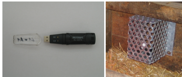
Abbildung 5: Handliches Messgerät mit integriertem Datenlogger, im Tierbereich geschützt
