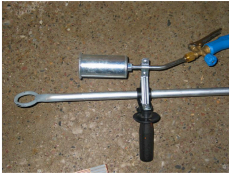
Abbildung 1: Um einen konstanten Abstand zur Oberfläche garantieren zu können wurde eine Halterung mit Fixierung des Brenners entworfen. Die Halterung konnte mit Hilfe eines Schlittens über die Oberflächen bewegt werden.
