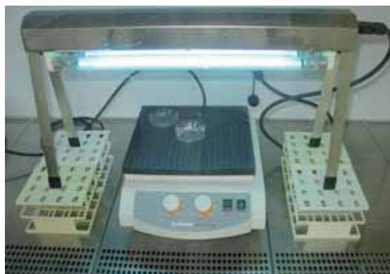
Abbildung 3: Experimenteller Aufbau der UV-Bestrahlung zur Erzeugung von Mutationen
