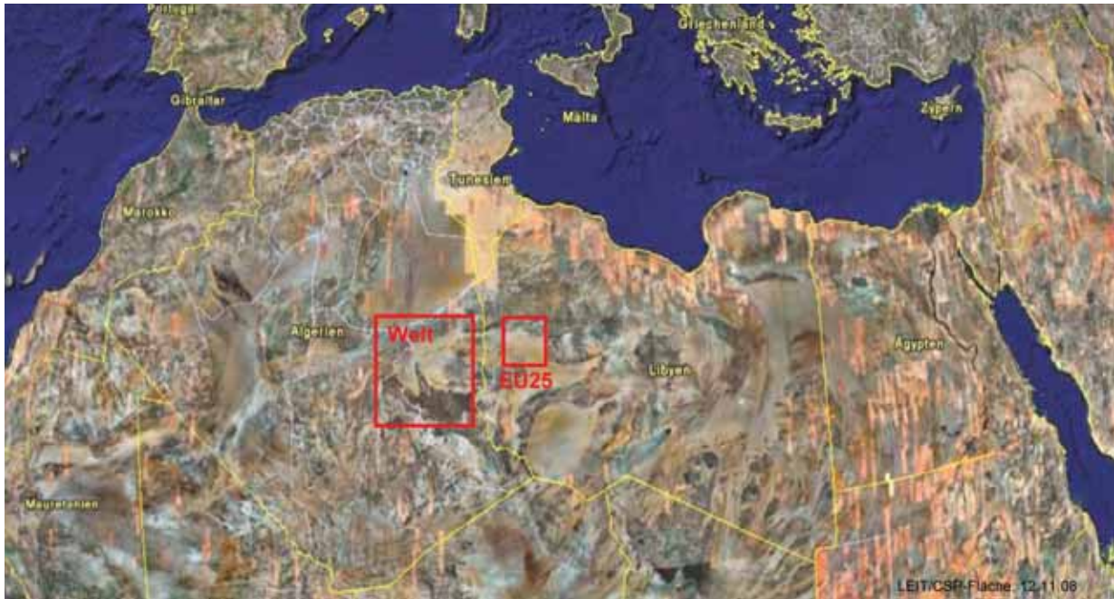
Abbildung 3: Rechnerischer Flächenbedarf für die Erzeugung des gegenwärtigen Stromverbrauchs der EU-25 bzw. der gesamten Welt mittels solarthermischen Kraftwerken heutiger Bauart
