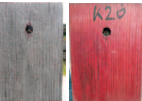
Abb. 5: Paraffin-behandelter Kieferprüfkörper nach drei Jahren Exposition in 45° geneigter Doppellagenanordnung – Decklage: Frontseite (links), Rückseite (rechts) – Paraffin-treated pine sapwood sample after three years of exposure in a 45° inclined double layer arrangement – top layer: front side (left), reverse side (right)
