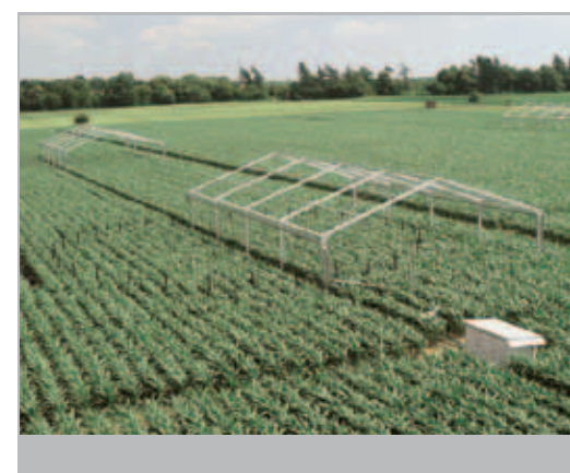
Abb 5: Maisfeld mit FACE-Ring zur Erhöhung der \text{CO}_2 -Konzentration und Zeltgerüsten zur Manipulation des Niederschlags – Maize field with FACE-rings for \text{CO}_2 enrichment and tent frames for control of precipitation
