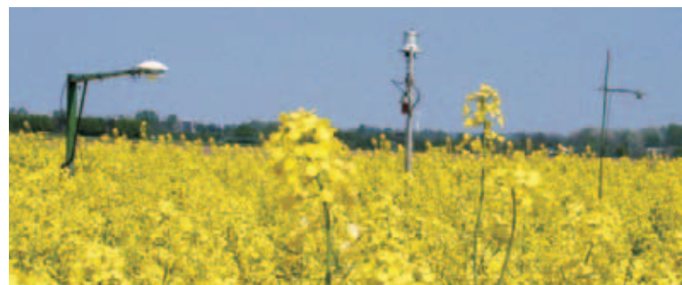
Abb. 5: Agrarmeteorologische Strahlungssensoren über einem Rapsbestand. Links: Albedometer, Mitte: Psychrometer (zur Messung der Luftfeuchtigkeit); rechts: ein abwärts- und aufwärtsgerichteter PAR-Sensor – Agrometeorological sensors above a rapeseed canopy. Left: albedo meter; centre: psychrometer (measurement of air humidity); right: downward and upward PAR sensor
