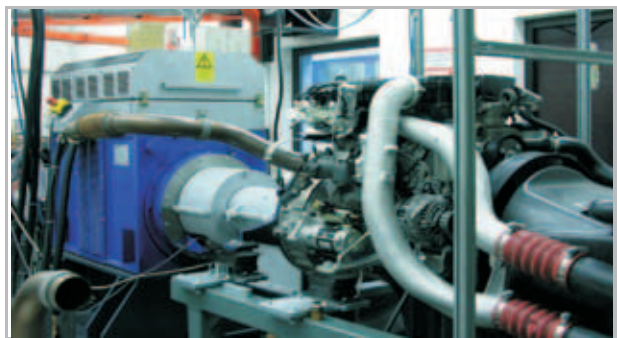
Abb. 10: Mercedes OM 904 Motor mit SCR-System im Emissionsprüfstand – Mercedes OM 904 engine with SCR-system on the emission test bench
