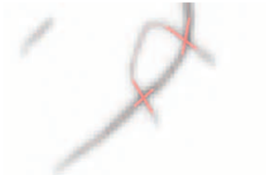
Abb. 8: Automatische Berechnung von überlappenden Fasern (rote Bereiche markieren Kreuzungsübergänge) – Automatic calculation of overlapped fibers (red areas mark cross-overs).
