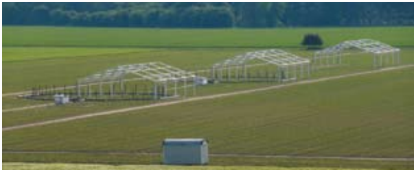
Abb. 3: Maisversuchsfeld im Juni mit FACE-Ringen zur Erhöhung der \text{CO}_2 -Konzentration und Zeltgerüsten zur Manipulation des Niederschlags – Maize field with FACE-rings for \text{CO}_2 enrichment and tent frames for control of precipitation
