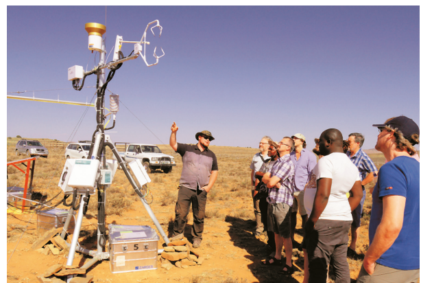
Aufbau einer neuen Messstation zur Erfassung der \text{CO}_2 -Flüsse in einem Savannenökosystem in Südafrika im Rahmen des Verbundprojekts Ars AfricaE
