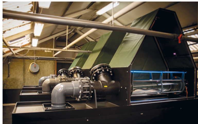
Die drei Druckkammer-Strömungstunnel im Testbetrieb (aufgebaut November 2015 in der Aquakulturanlage im FI-Ahrensburg) (© B. Illing/Thünen-Institut)
