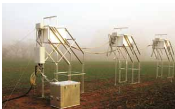
Haubenanlage zur automatisierten Erfassung der \text{N}_2\text{O} - und \text{CH}_4 -Flussraten an der Schnittstelle Boden-Atmosphäre (© Thünen-Institut für Agrarrelevante Klimaforschung)
