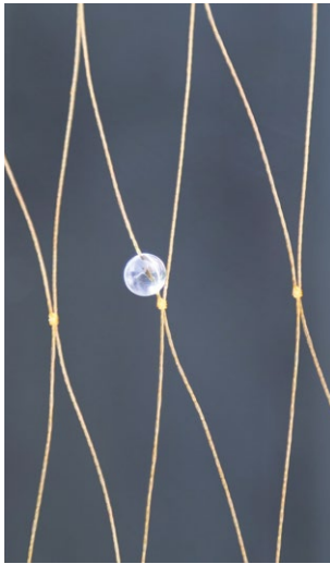
Perlennetz (links) zur Vermeidung von Schweinswalbeifängen in der Stellnetzfisherei, und NEMOS+Roofless-Steert (rechts, Blick gegen die Schlepprichtung) zur Reduzierung der Dorschbeifänge in der gemischten Grundsleppnetzfisherei der Ostsee. (© Daniel Stepputtis)
