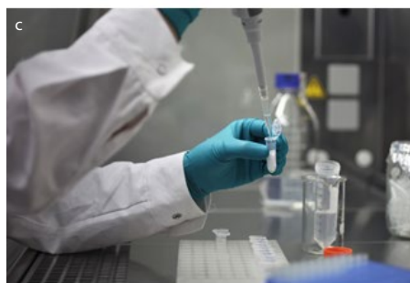
Probenaufbereitung zur Analyse von Umwelt-DNA. Meerwasser wird auf Membranen filtriert (a, b), die daran haftende Umwelt-DNA wird anschließend extrahiert (c) und analysiert (d). (© Thünen-Institut)
