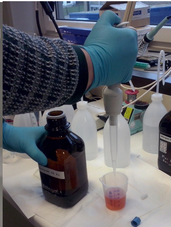
Abbildung 7: Pipettierung von Chemikalien (im Bild: Kaliumjodid) für die Bestimmung des Titors.
