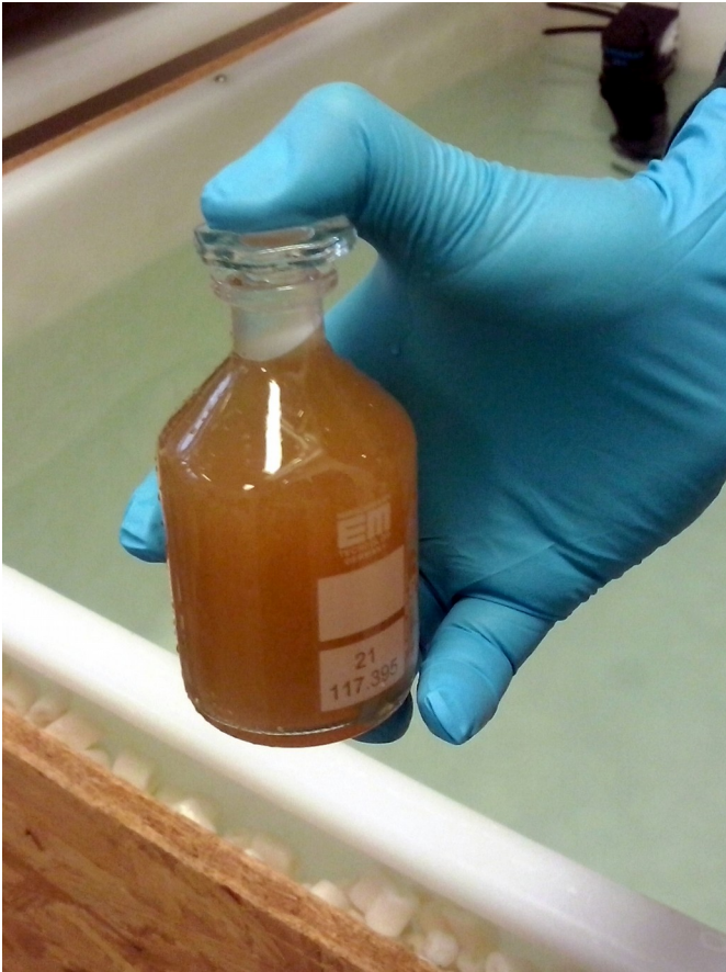
Abbildung 10: Fertig genommene Sauerstoffprobe
