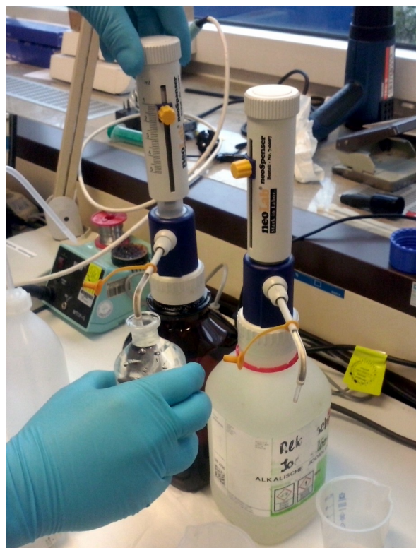
Abbildung 9: Versetzung von Mangan-Reagenz und alkalischer Jodidlösung
