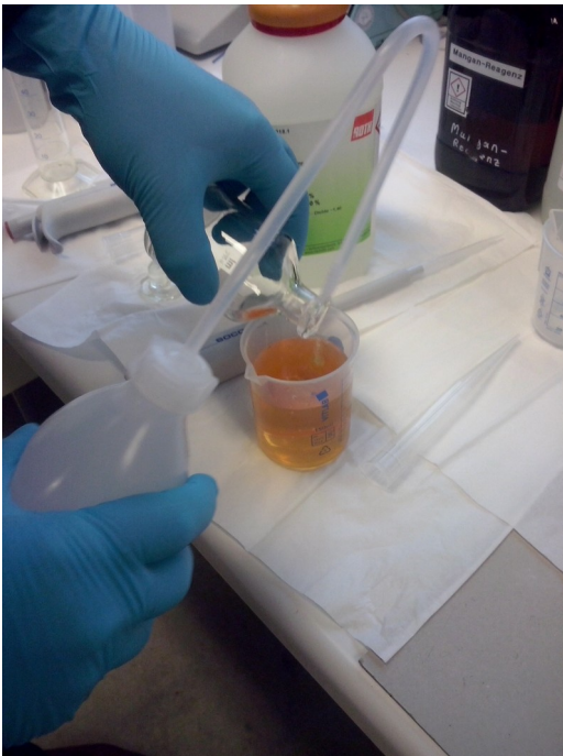
Abbildung 13: Spülung von Stopfen und Sauerstoffflasche über Becherglas mit destilliertem Wasser.
