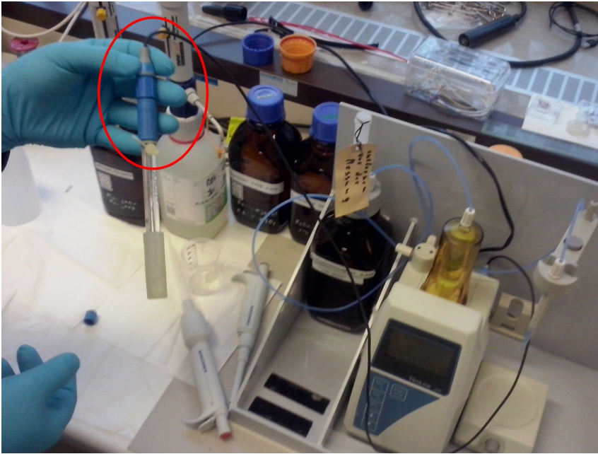
Abbildung 5: Elektrode an Titrator angeschlossen.
