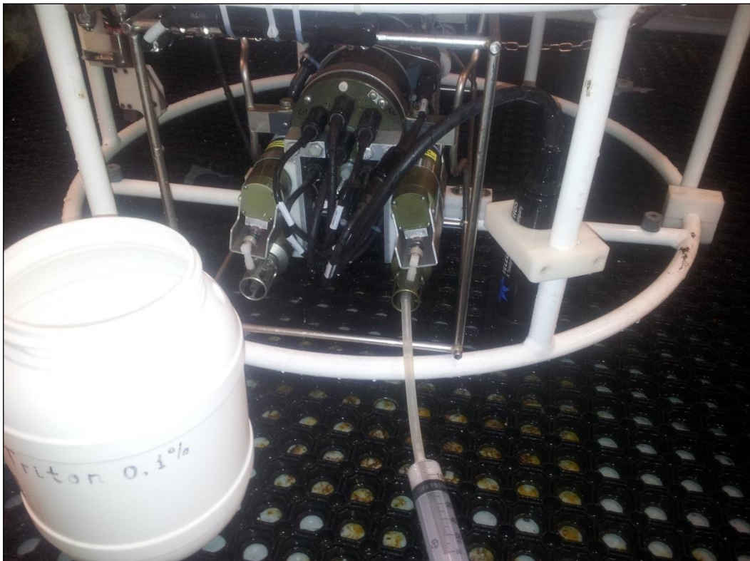
Abb. 11. Sensorzellenreinigung mit Spritze (Tritonlösung, Süßwasser oder De-Ionized Wasser).
