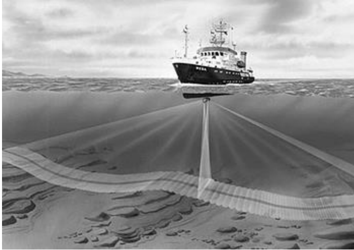
Abbildung 2: Darstellung eines Fächerlots. Quelle: Mit freundlicher Genehmigung des Bundesamts für Seeschifffahrt und Hydrographie (BSH).
