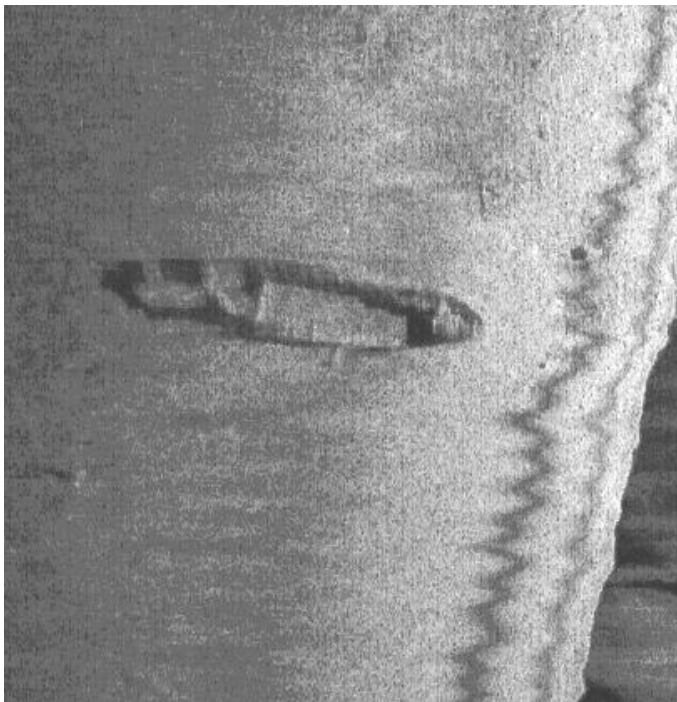
Abbildung 3. Schiffswrack auf dem Meeresboden in der Nähe von Kapstadt, Südafrika. Aufgenommen mit einem Seitensichtsonar im März 2011. Quelle: Wikimedia.org, http://upload.wikimedia.org/wikipedia/commons/9/93/Wreck_east_of_Ark_Rk.jpg
