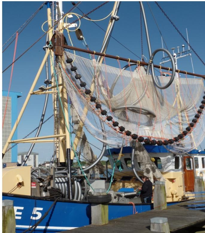
**Abbildung 147:** De Boer RVS Garnelensortierung. Die Trommel mit aufgewickeltem Vakuumschlauch
