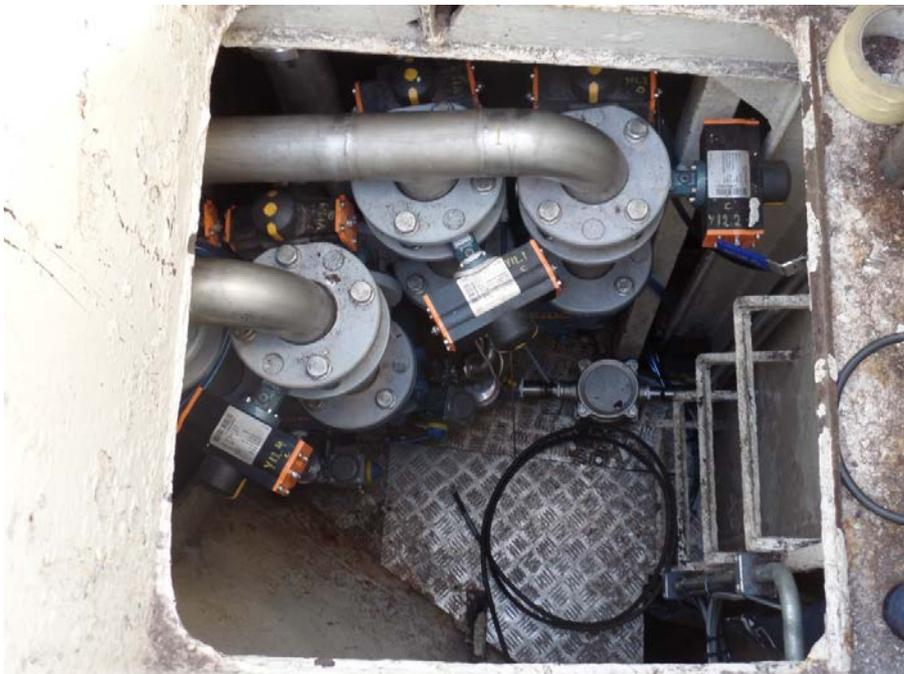
**Abbildung 150:** De Boer RVS Garnelensortierung. Die großen Vakuumbehälter mit im Hintergrund befindlichem Tank, aus dem der Fang auf die vier Förderbänder gelangt
