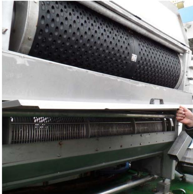
**Abbildung 142:** Beispiel einer Trommel-Sortiermaschine mit vorgeschalteter Bakelit-Loch-Trommel und drei Segmenten von Edelstahlsieben mit 6,2 und zwei mal 6,0 mm Stababstand am Ende hergestellt von der Firma Verburg, Niederlande
