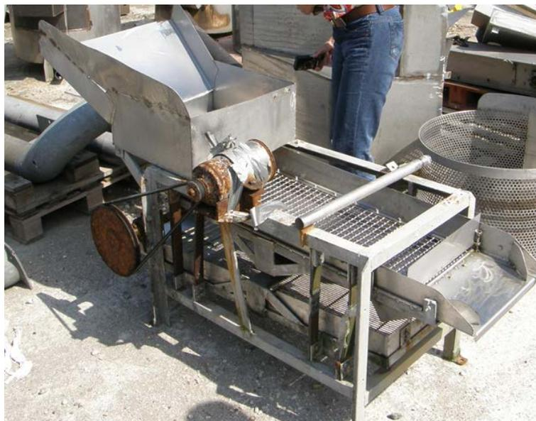
**Abbildung 141:** Ausschnitt zum Beispiel einer modernen, zweistufigen Trommel-Sortiermaschine hergestellt von der Firma de Boer, Niederlande: Oben große Bakelit-Lochtrommel mit 14-mm-Löchern, die vor allem Fisch- und Krebsbeifang aussortiert, da nur kleinere Garnelen und Fischchen nach unten in die zweite Stufe gelangen können; unten Schlitz-Trommeln mit drei Abschnitten von 6,0 und 6,2 sowie 6,4 mm Stababständen, die eine Größen-Auswahl für Garnelen- Discard und Kochfraktion ermöglichen.
