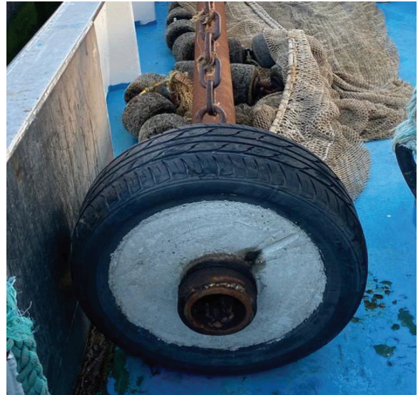
An der Baumkurre angebrachter Reifen als Ersatz für Kurrschuhe
