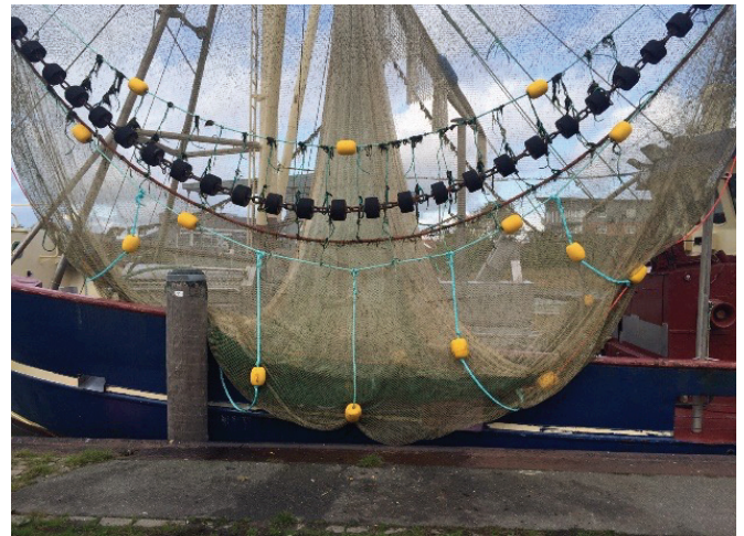
Angebrachtes Tau-Bojen-Geflecht am Krabbenetz auf SU8
