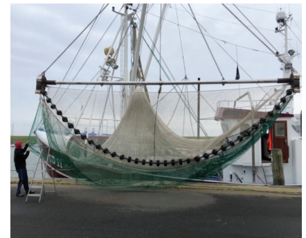
Rollengeschirr auf SD11 Hindenburg. Rollenbeschläge verkanten auf der Welle und lassen sich nicht wie beabsichtigt drehen.
