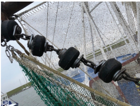
Rollengeschirr auf SD11 Hindenburg. Rollenbeschläge verkanten auf der Welle und lassen sich nicht wie beabsichtigt drehen.
