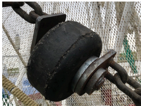
Rollengeschirr auf SD11 Hindenburg. Rollenbeschläge verkanten auf der Welle und lassen sich nicht wie beabsichtigt drehen.
