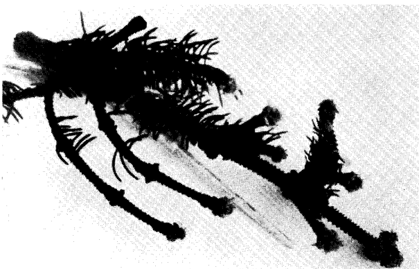
Abb. 22. — Fichtenzweig mit Widerstandsthermometer; Beutelhülle: Pergamintüte; Nadeln größtenteils abgefallen.
