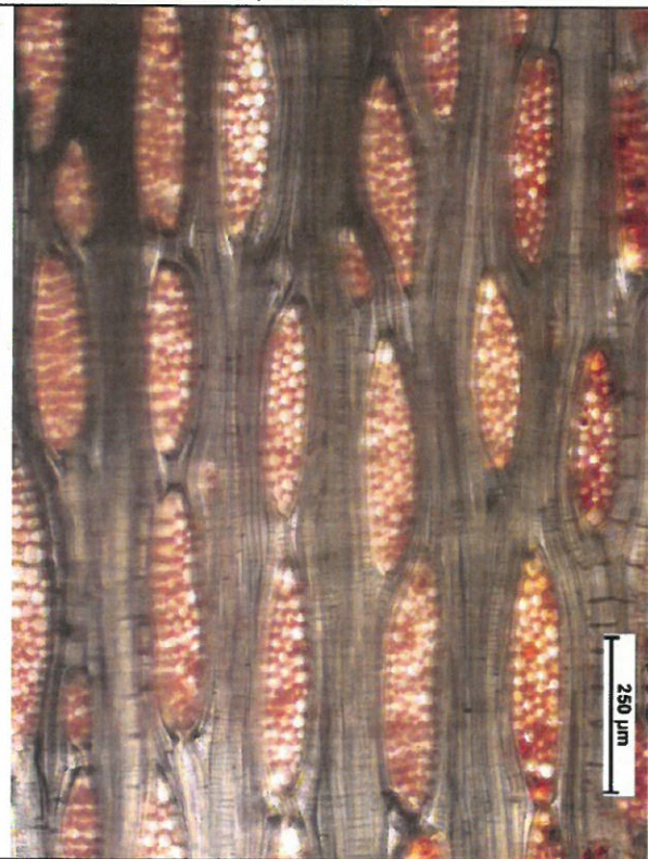
Foto 8: T; Bereich mit stockwerkartiger HS-Anordnung; M 100:1
