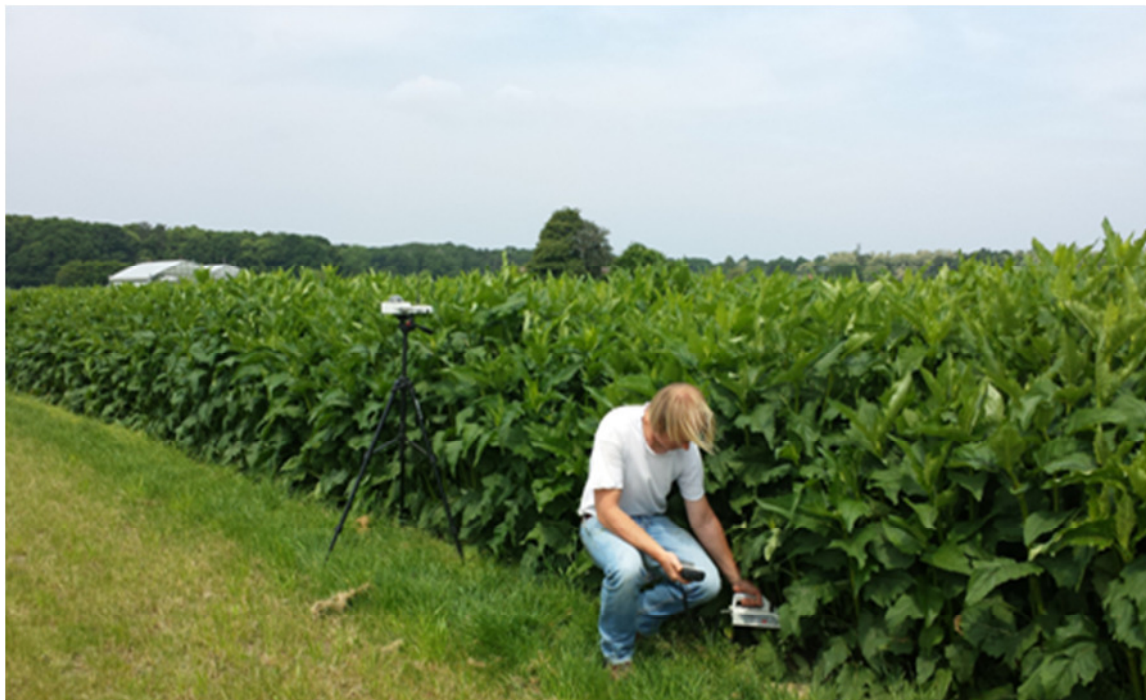
Abbildung 51: Ermittlung von PAR-Interzeption und Blattflächenindex mit dem SunScan System bestehend aus Stabquantensensor und externem PAR-Sensor mit RadioLINK zur Messung der PAR oberhalb des Blätterdachs. Messung nur zu Demonstrationszwecken am Parzellenrand, sonst im Bestand.
