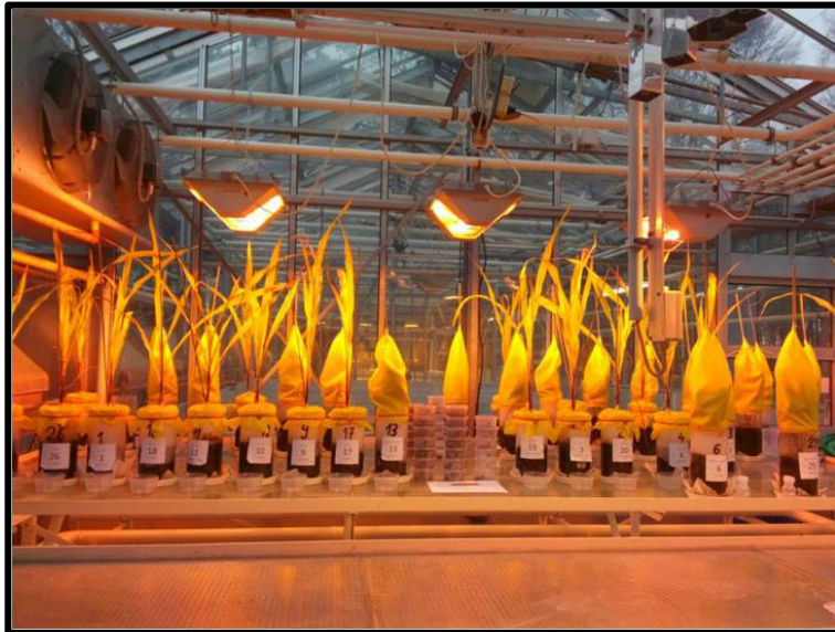
Abbildung 34: Aufbau des Phytokosmenversuchs unter standardisierten Bedingungen im Gewächshaus.
