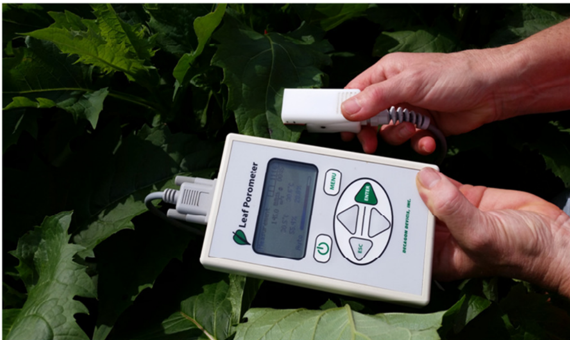
Abbildung 49: Messung der stomatären Leitfähigkeit mit dem SC-1 Porometer an einem Silphieblatt in Braunschweig 2014.
