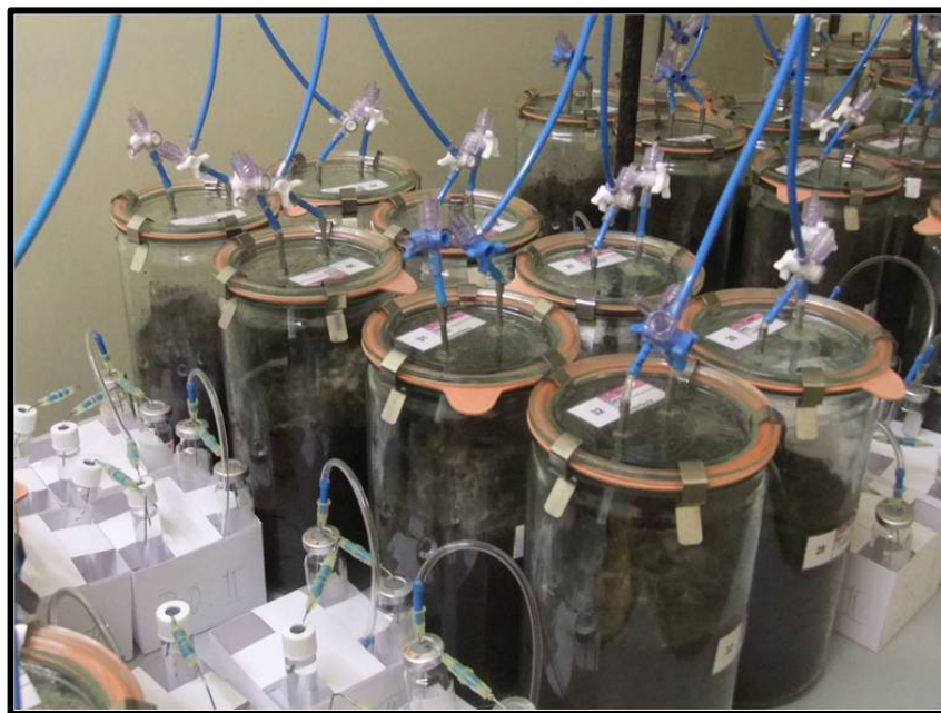
Abbildung 31: Gasdicht verschlossene Boden-Mesokosmen angeschlossen an ein Durchflusssystem. Probenflaschen sind den Mesokosmen nachgeschaltet.
