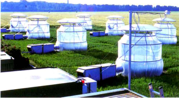
Abb. 3-2: Versuchsfeld der ehemaligen FAL Braunschweig mit Open-Top-Kammern zur Untersuchung des \text{CO}_2 -Düngeeffekts auf Sommerweizen.
