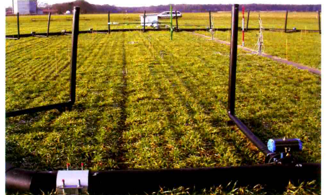
Abb. 3-3: Braunschweiger FACE-Anlage. Oben: schematische Darstellung der Aufsicht und Querschnitt eines Begasungsringes. Unten links: Foto zweier Versuchsrings kurz nach dem Aufbau (Oktober 1999) während des Fruchtfolgeversuchs mit Wintergerste (nach DÄMMGEN 2000). In den weißen Schränken befindet sich unter anderem das Steuerungsventil zur Dosierung des \text{CO}_2 . Das Gebläse, mit dem das \text{CO}_2 mit Luft verdünnt und in die Ringleitung eingeblasen wird, ist durch die Schränke verdeckt. Unten rechts: Foto mit Detailansicht der Ringleitung und eines Ausströmröhres mit pneumatischer Klappe.“
