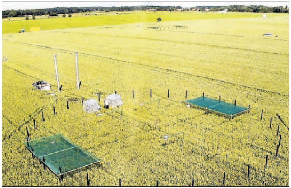
Auf einem Acker des Von-Thünen-Instituts in Braunschweig sind Säulen aufgestellt, aus denen das kreisförmige Versuchsfeld mit CO 2 besprüht wird. So wird die Auswirkung des Gases auf den Ernteertrag ermittelt. Foto: vTI
