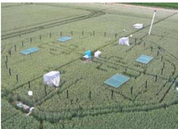
Luftaufnahme eines FACE-Versuchsrings in einem Weizenfeld des vTI. Durch die Düsen in den schwarzen senkrechten Röhren wird CO 2 in die Kreisfläche geblasen. (Foto: vTI/BD)
