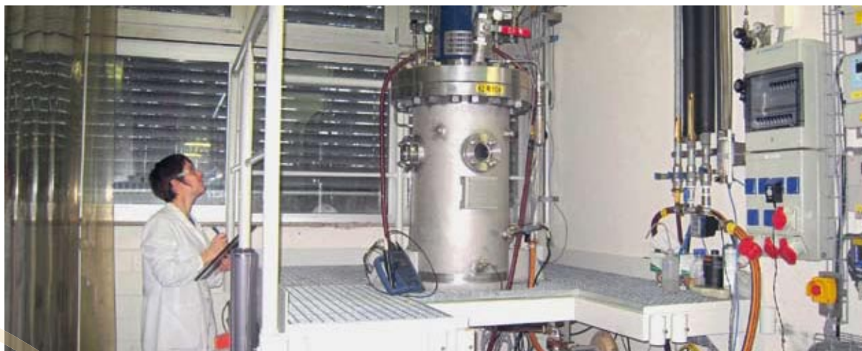
Abb. 6: Pilotreaktor zur Zuckeroxidation bei der Südzucker AG
